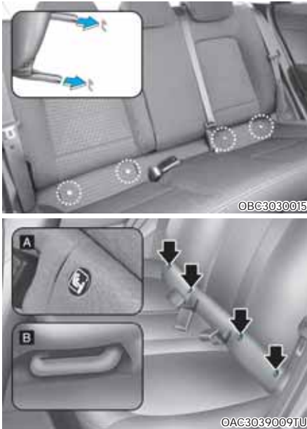
[A] : Kennzeichnung der Lage des ISOFIX Ankerpunkts, [B] : ISOFIX Ankerpunkt
